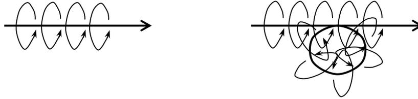
Al enrollar el alambre de cobre, el campo magnético se incrementa al doble por cada vuelta (espira) que le damos. Una bobina, es un alambre enrollado. Al circular corriente se genera un campo magnético orientado según la polaridad de la corriente. Si atravesamos una varilla de hierro, este se magnetizará, creando un electroimán si la corriente es continua.
